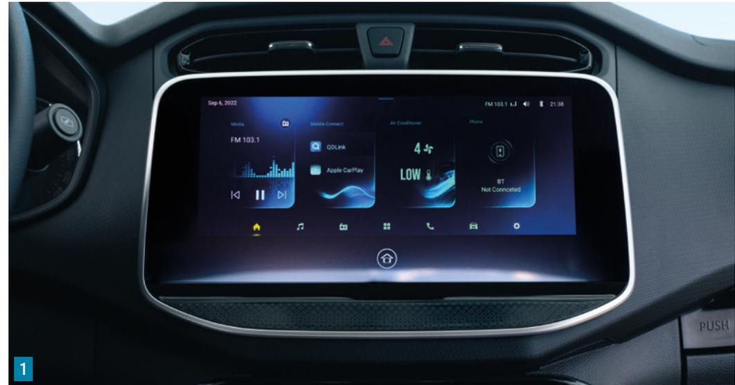
**1** Über den zentralen 10,25 Zoll großen Touchscreen sind die wichtigsten Fahrzeugdaten abrufbar. Smartphones können mittels Apple CarPlay, QD-Link (Android Screen Mirroring) und Bluetooth verbunden werden. Das Bild der serienmäßigen Rückfahrkamera erleichtert das Rangieren.
